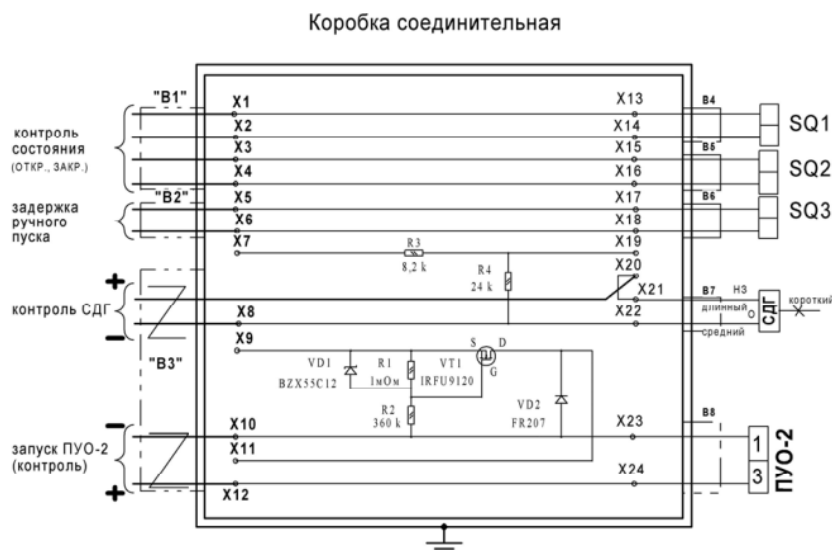
Рис. 20. Схема подключения УРУ исполнения ЭР к приемно-контрольной аппаратуре
