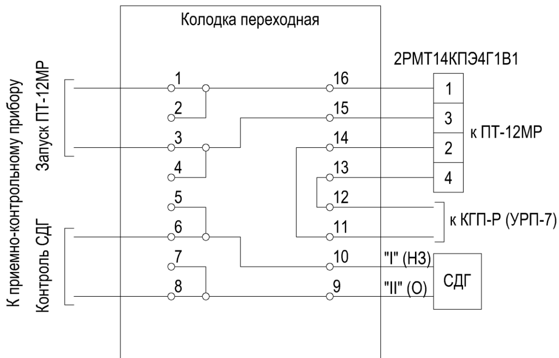
Рисунок Б.13 – Схема подключения ПТ-12МР к переходной колодке
