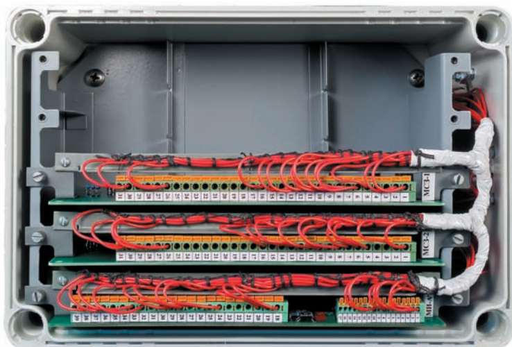
Рис. 13. БМ5-М без крышки с электронными модулями
