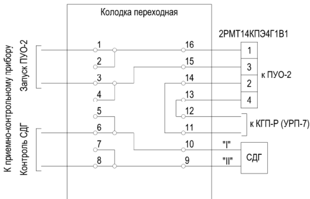
Схема подключения ПУО-2 и СДГ к переходной колодке
